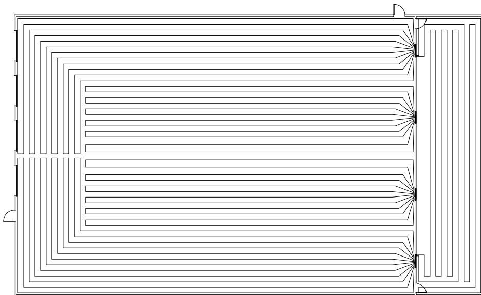
Figure 10-4 : Installation de tuyaux à couverture variée
