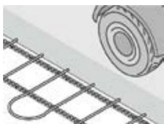
Uponor Magna je sustav koji se ugrađuje izravno u betonske ploče. Standardna čelična armatura betonskih ploča može se koristiti za pričvršćivanje cijevi grijanja. Može se koristiti bilo koji sustav grijanja za pripremu vode.
