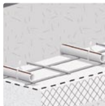
Rýchle a jednoduché upevnenie rúrky na oceľovú sieť
