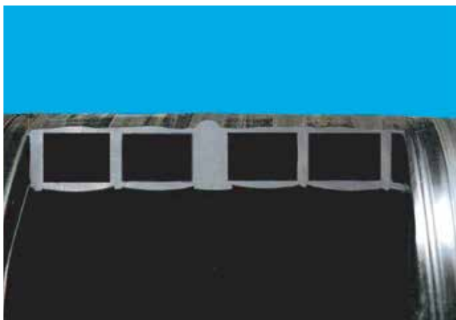
Svetsad fog genom rörprofilen.
