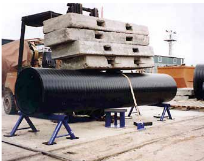
Längdstyvhetstest för ett DN/ID 600 mm, SN4 rör. Last 29 kN, deformation 30 mm, rördeformation 54 mm.
