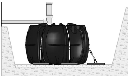
Forankring med forankringsplader.
