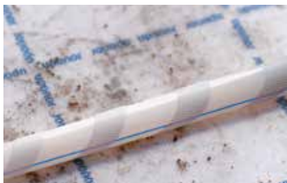
L'adesione del tubo rimane perfetta anche col normale sporco di cantiere
