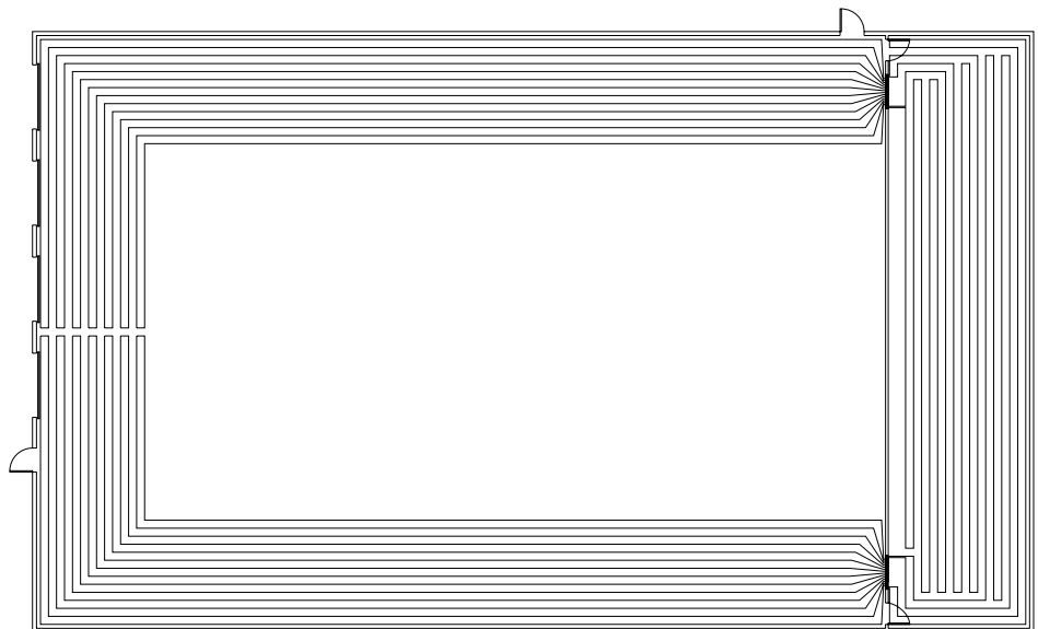
Figure 10-2 : Installation de tuyaux à couverture complète
