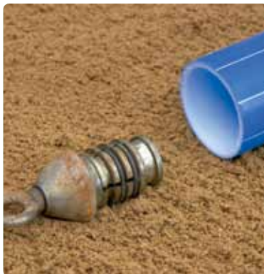
Trækhovedet til trækning af ProFuse-rør placeres i røret og ekspanderes, således at samlingen bliver trækfast.
