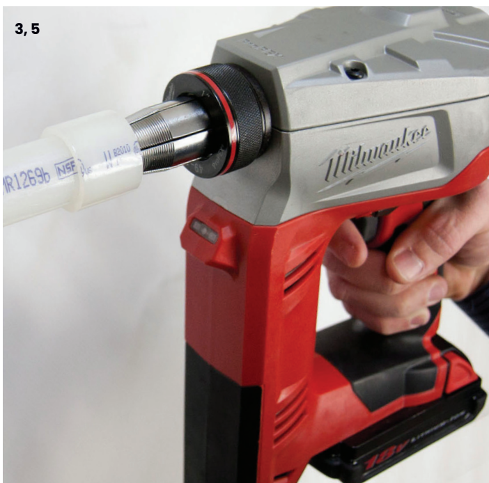
Figura 2-9: Expansión con la herramienta expansora ProPEX M18 de Milwaukee
