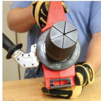
Figura 2-13: Alineación correcta del cabezal de expansión
