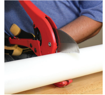
Figura 2-14: Cortar la tubería
