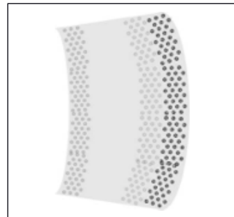
Figura 1-2: PEX-b (Silane) reticulación del 65 a 70 %
