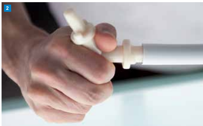
Kalibracija Pred samo izdelavo spoja, se mora konec cevi kalibrirati.
