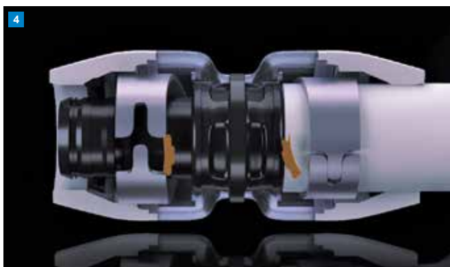
Kontrola Uspešno izveden spoj je moč videti skozi transparentno inšpekcijsko okno. Če je bil barvno označene varnostni distančnik potisnjen s stiskalnega obroča, je zatisni obroč zaprt/stisnjen.
