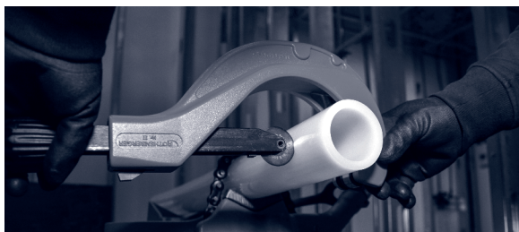
Figura 33: Cortatubos estilo cortador de tubería giratorio de Uponor para tubería hasta 4" (E6084000)
