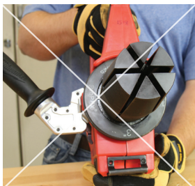
Figura 12: "Florecimiento" incorrecto del cabezal de expansión
