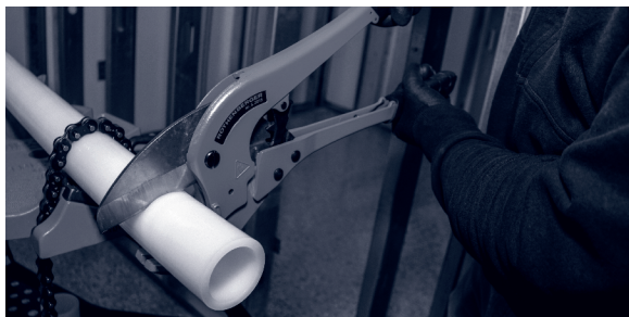
Figura 34: Cortatubos estilo tijera trinquete para tubería de Uponor para tubería hasta 3" (E6083000)
