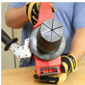
Figura 13: Alineación correcta del cabezal de expansión
