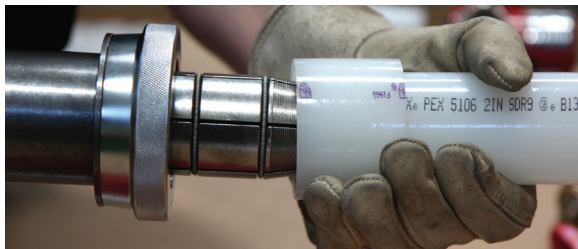
Figura 22: Deslizar el cabezal en la tubería
