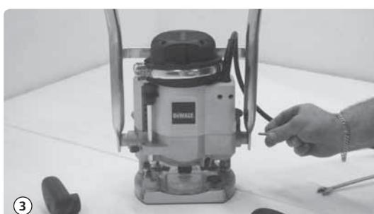
Skruta fast stativet i fräsmaskinen med de medföljande bultarna.
