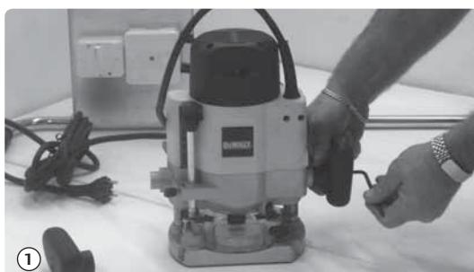
Börja med att montera bort fräsmaskinens handtag.
