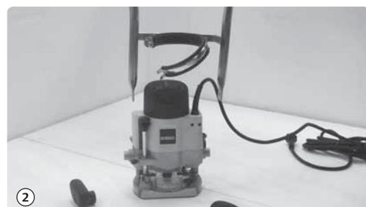
Därefter placeras stativet på fräsmaskinen.
