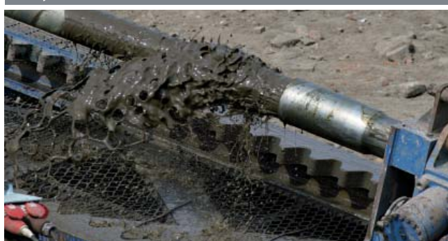
Fot. 8. Moment rozkręcania żerdzi płuczkowych 6 5/8”.
