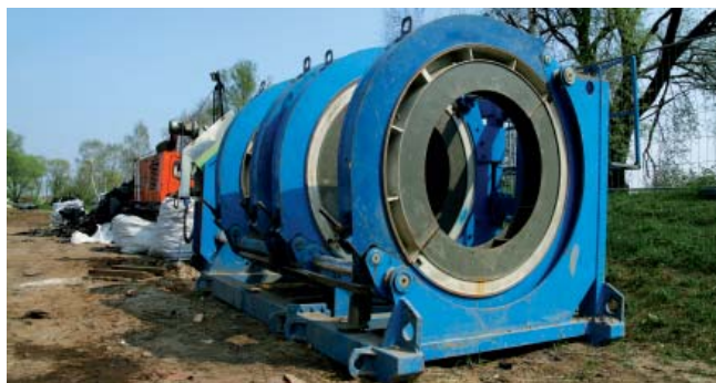
Fot. 4. Zgrzewarka do rur polietylenowych o średnicach do 1600 mm
