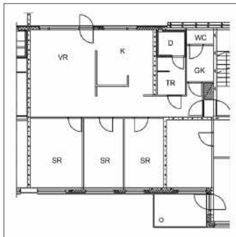
Bild: Kanalen ska placeras så långt bort som möjligt från det ljudtekniskt mest krävande rummet.
