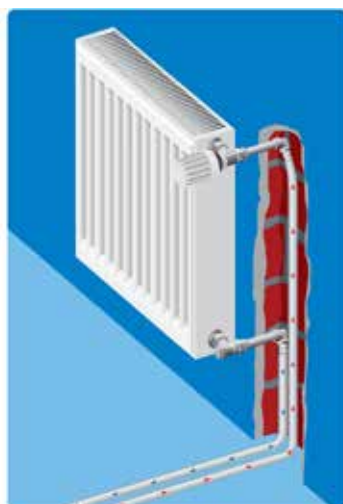
Podejście do grzejnika typu C za pomocą kolana naściennego Uponor MLC.
