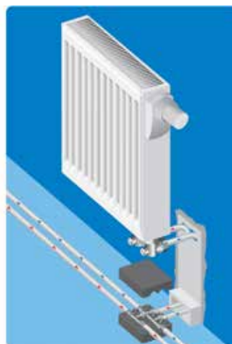
Podejście do grzejnika typu VK, sterowanego termostatem, za pomocą grzejnikowej jednostki połączeniowej Uponor MLC, mocowanej do ściany. Podłączenie do rurociągu za pomocą trójnika krzyżakowego Uponor MLC.
