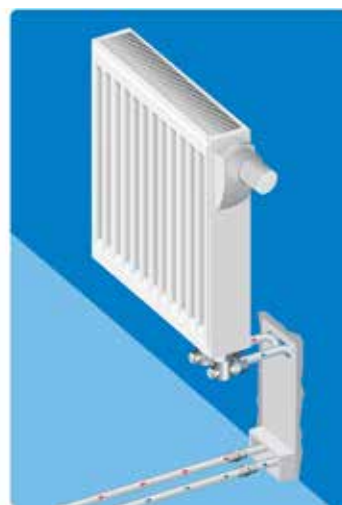
Podejście do grzejnika typu VK, sterowanego termostatem, za pomocą grzejnikowej jednostki połączeniowej Uponor MLC, mocowanej do ściany.
