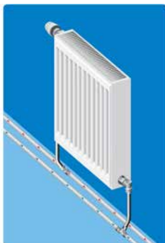
Podejście do grzejnika typu V za pomocą zamontowanego w podłodze trójnika zaprasowywanego Uponor MLC.
