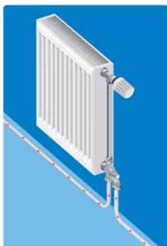
Podejście jednopunktowe do grzejnika typu C z zaworem czterodrogowym za pomocą adaptera kompresyjnego Uponor MLC, wychodzącego z podłogi.
