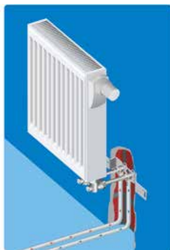
Podejście do grzejnika typu VK, sterowanego termostatem, za pomocą stelażu 35/50 mm, kolana naściennego Uponor MLC i rury wychodzącej ze ściany.
