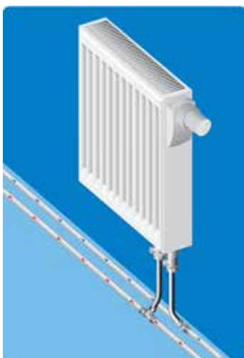
Podejście do grzejnika typu VK, sterowanego termostatem, za pomocą zamontowanego w podłodze trójnika zaprasowywanego Uponor MLC.
