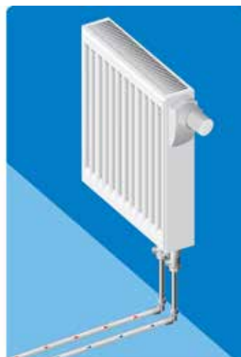
Podejście do grzejnika typu VK, sterowanego termostatem, za pomocą kolana naściennego, zamontowanego w podłodze.
