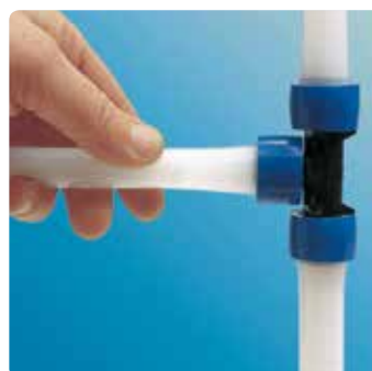
Montaż – rurę należy nałożyć na końcówkę złączki i chwilę potrzymać, aż się skurczy.
