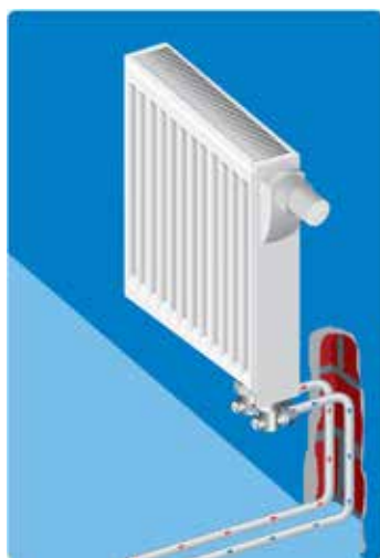
Podejście do grzejnika typu VK, sterowanego termostatem, za pomocą adaptera Uponor MLC, mocowanego do ściany.
