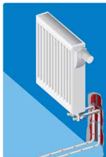
Podejście do grzejnika typu VK, sterowanego termostatem, za pomocą podwójnego kolana naściennego Uponor MLC.
