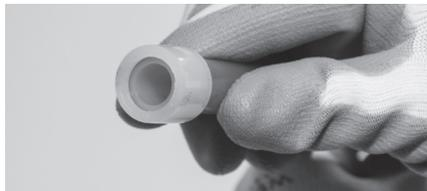
Figure 3-8 : Glisser la bague jusqu'à ce que le tuyau touche au bord d'arrêt
