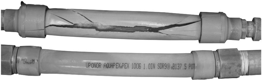
Figure C-2 : Test de gel, PVC-C vs PEX
