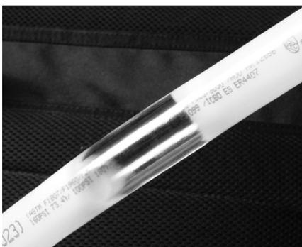
Figure C-1 : Reformer un tuyau déformé
