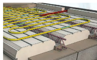
Plancher en dalle de compression
