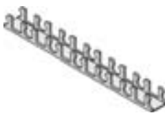
Samoprzylepna U-kształtna szyna montażowa do montażu rur o \varnothing 16 mm w odstępach co 5 cm.
