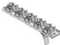
Samoprzylepna szyna montażowa do montażu rur o \varnothing 14 \div 20 mm w odstępach co 5 cm
