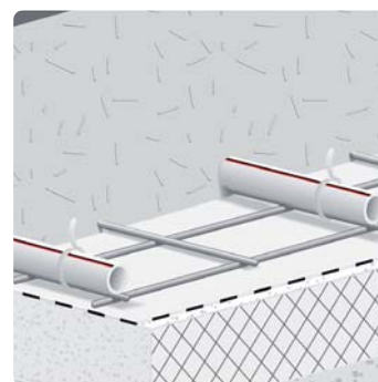
Brzo i lagano pričvršćivanje cijevi na čeličnu mrežu
